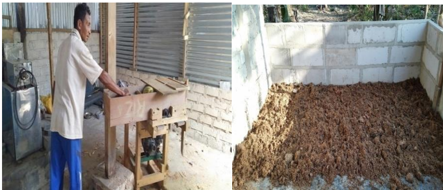
Gambar 2. Proses penghancuran sabut kelapa muda
