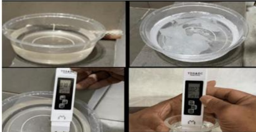
Gambar 5. Kondisi sebelum dan sesudah difilter dengan alat filter bertahap
